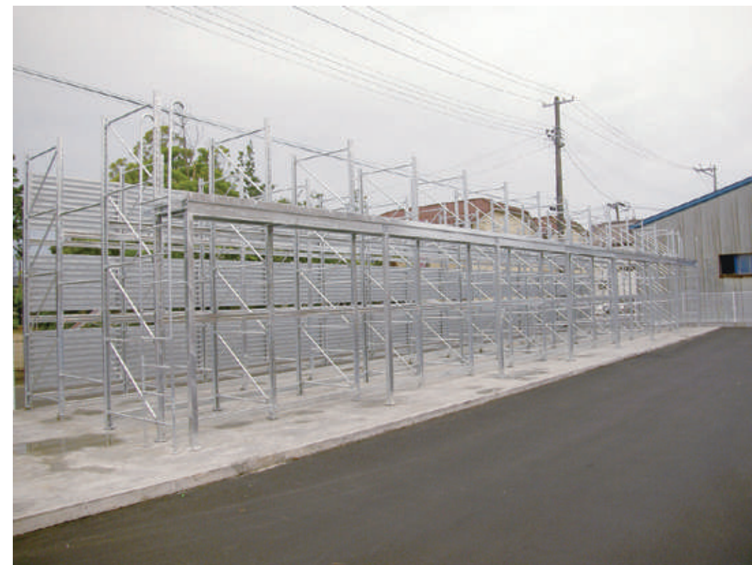
溶融亜鉛メッキ(重量ラック、架台)
